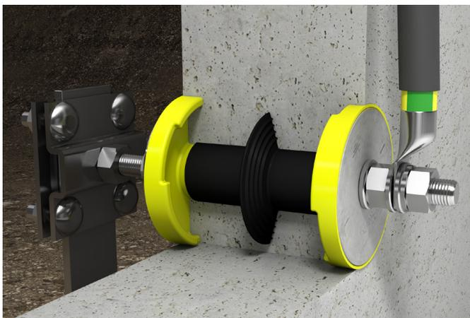
Erdungsdurchführung HEA-IS-M12: auf der einen Seite Anschluss eines Flachstahls über Kreuzklemme Z-KG-M12 und auf der anderen Seite Anschluss eines Erdungsleiters über den Anschlussbolzen Z-B-M12.
